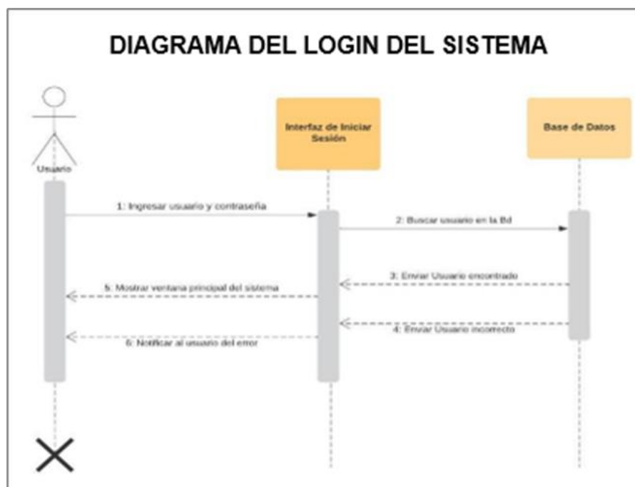
Gráfica N° 1. Muestra la interacción del usuario con el sistema, relacionándose directamente con la interfaz del login y la base de datos.
