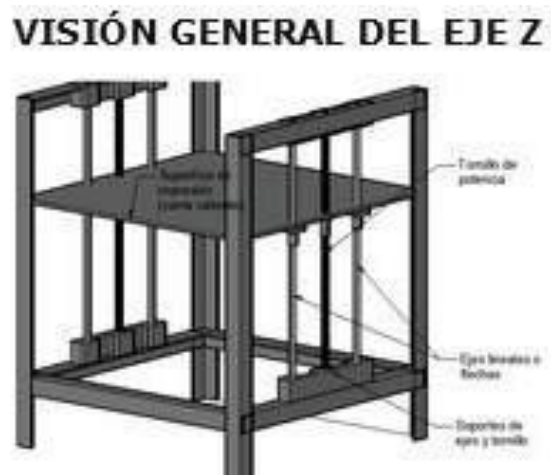
Gráfica N° 4. Conformado de eje Z.
