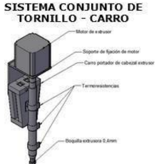
Gráfica N° 3. Conjunto tornillo extrusor-carro porta extrusor.
