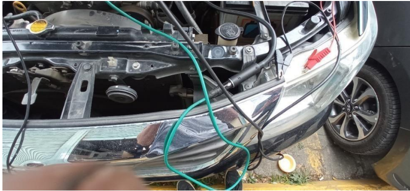
Gráfica N° 5. Conexión de transductor.
