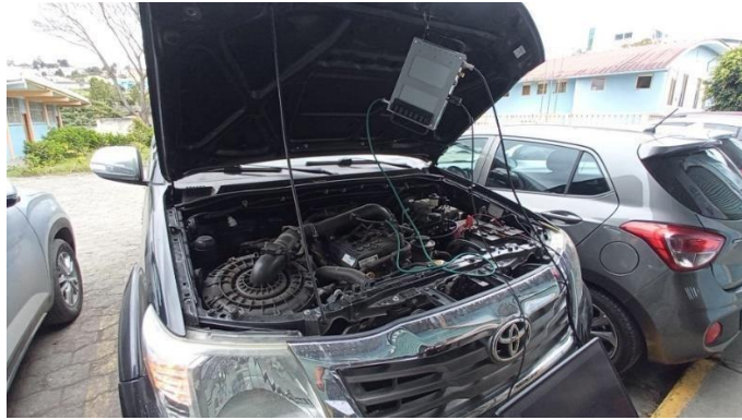
Gráfica N° 7. Osciloscopio Instalado En El Vehículo.
