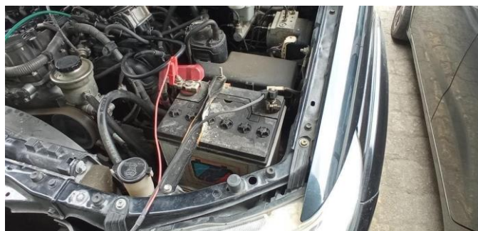
Gráfica N° 4. Conexión Alimentación De Osciloscopio.
